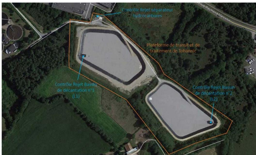
Figure 2 : Points de contrôle des rejets des eaux
