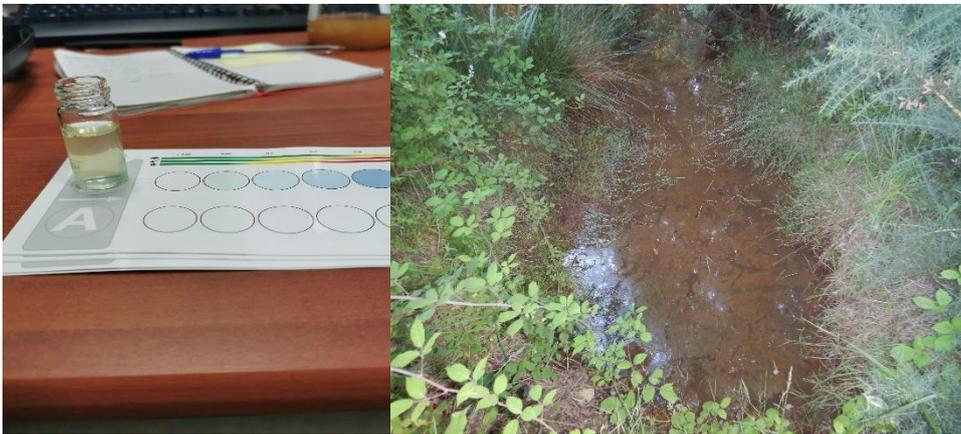
Figure 2 : Exemple de test relatif au Phosphate (PO<sub>4</sub>) avec nuancier ProAquaTest LAB (à gauche) effectué au niveau de la zone humide ZH 2 (à droite) - Photos : V. GUIHO – TBM environnement, 2021
